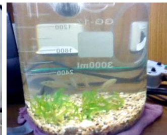
照片2 微過濾膜結合同步電混凝/電過濾（EC/EF）程序處理台江地區水產養殖區旁溝渠水道 (a) 溝渠景觀；(b) 濾液盛裝於燒杯中；(c) 養殖魚苗測試。
