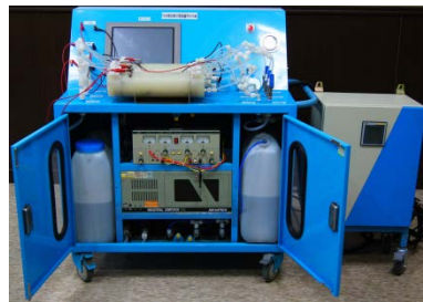
照片1 移動式同步電混凝/電過濾處理系統 (a) 外觀；(b) 內視。
