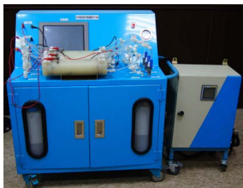
照片1 移動式同步電混凝/電過濾處理系統 (a) 外觀；(b) 內視。
