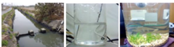
照片2 微過濾結合同步電凝/電過濾 (EC/EF) 程序處理台江地區水產養殖區旁溝渠水 (a) 溝渠景觀；(b) 濾液盛裝於燒杯中；(c) 養殖魚苗測試。
